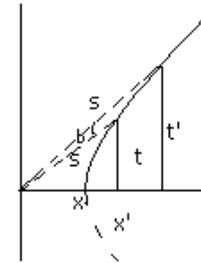
$$\begin{bmatrix} x' \\ t' \end{bmatrix} = \begin{bmatrix} \cosh b & \sinh b \\ \sinh b & \cosh b \end{bmatrix} \begin{bmatrix} x \\ t \end{bmatrix}$$
