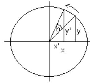
$$\begin{bmatrix} x' \\ y' \end{bmatrix} = \begin{bmatrix} \cos b & -\sin b \\ \sin b & \cos b \end{bmatrix} \begin{bmatrix} x \\ y \end{bmatrix}$$
